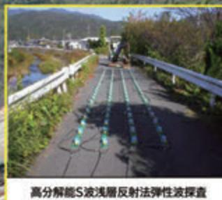
高分解能S波浅層反射法弹性波探査
