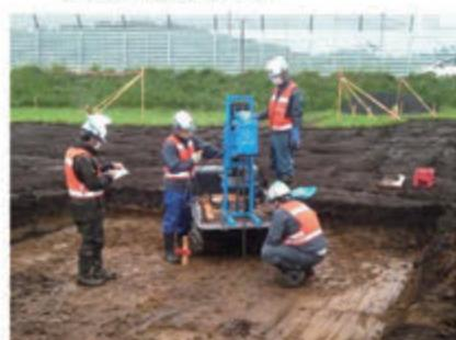
工事現場の土、砂、岩に対する物理試験やコンクリート用骨材の試験などを行い土木構造物の材料として適切かどうかを判断します。
