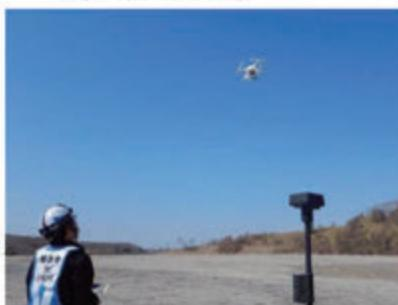
土木構造物の設置を行う上で、位置情報の取得、資料作成のために地上レーザスキャナ・UAV等各種最新機器を用いて様々な測量を行っています。
